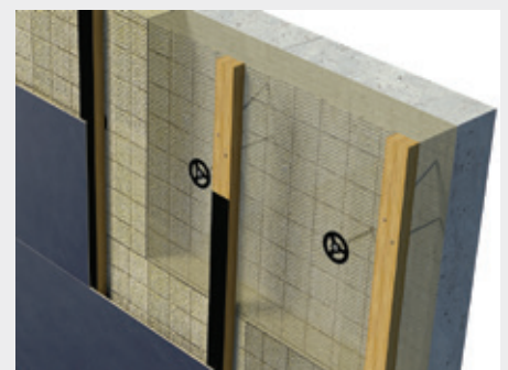
Thermisch geoptimaliseerde bevestigingswijze met afstandschroeven
